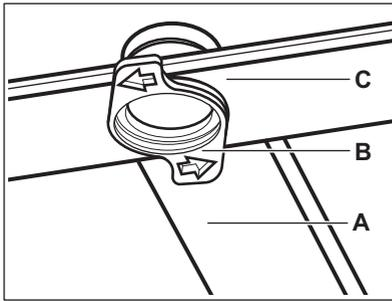
1. Entfernen Sie die Anschläge von den Gleitschienen der Besteckschublade und ziehen Sie die Schublade heraus.
